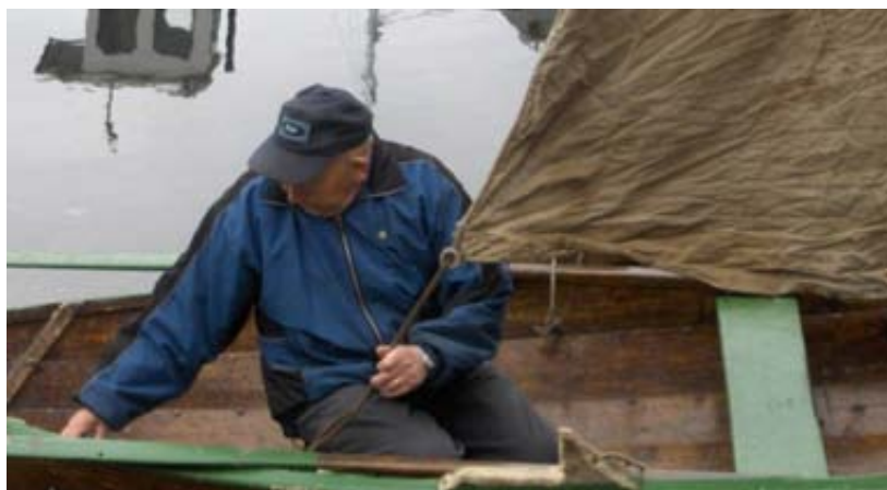
John prøver å feste storseglskjøtet, men holet i ripa var ikkje bora på denne færingen.
