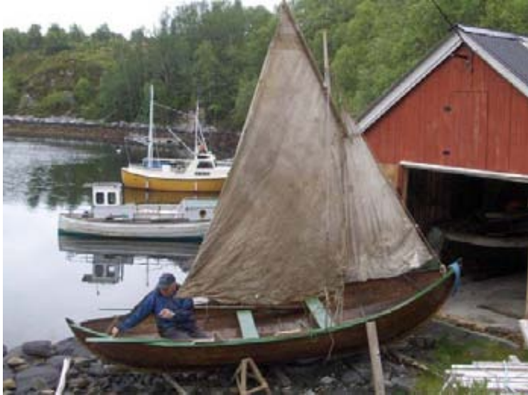
John riggar færingen i støa med storsegl og fokke. (9.7.2008)
