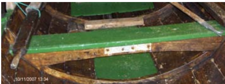
Toftene, tverrfjølene som ein sit på i ein færing. (10.11.2007)
