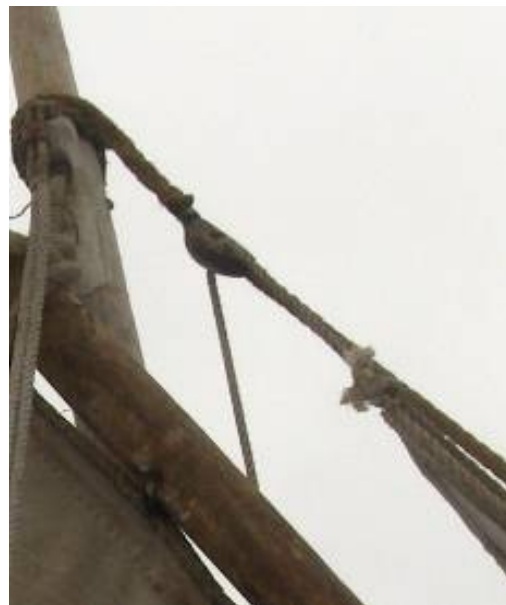
Fokkefallet festa med pålestikk i fokka, som vidare går gjennom ei blokk som er seisa fast i staget.
