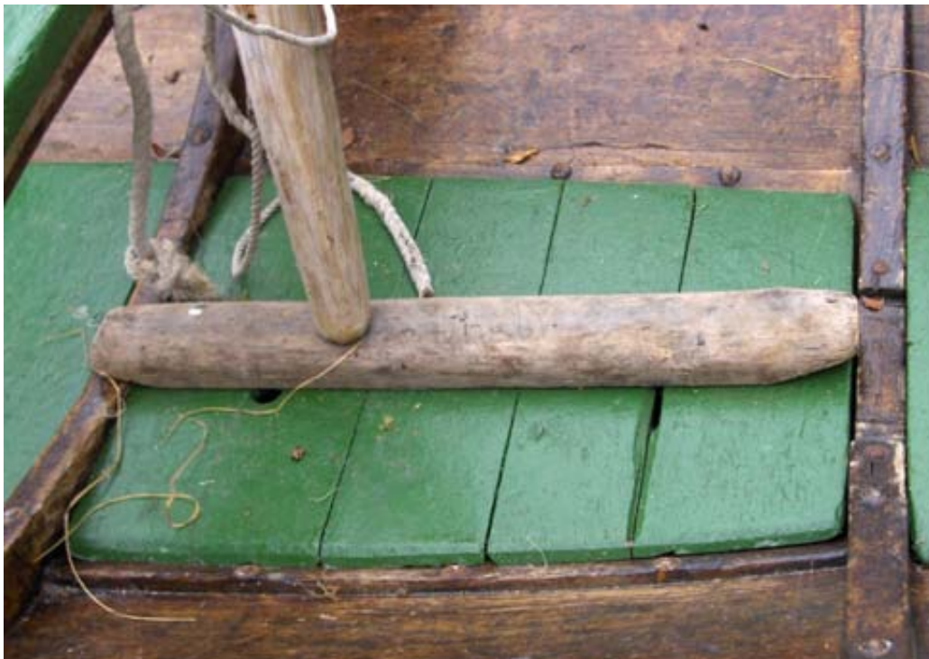
Spora plassert like framfor framtofta, oppå ei tilje, mellom to renger.
