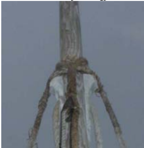
Innfesting av stag og vanta i mastetoppen.
