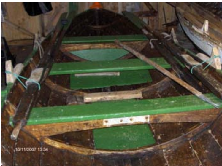
Framskuten nærast, så kjem framromet, bakromet og bakskuten. (10.11.2007)
