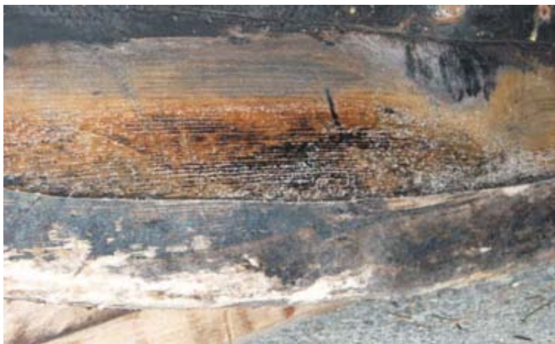
Draget på gamlefæringen er ei solid slitefôring festa nedst på kjølen.
