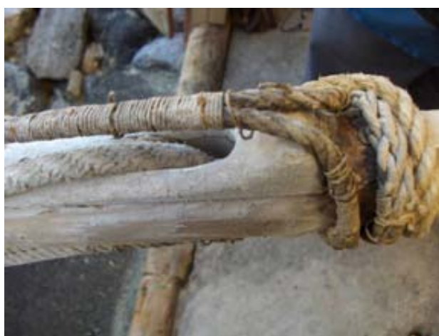
Rundt stag og vant finn vi seisingar av hampetråd for å verne spleisen og regulere storleiken på lykkja.
