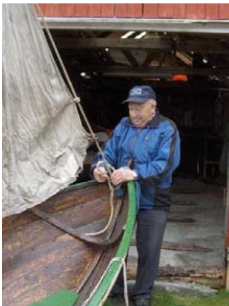
John festar staget i eit øye i framstammen. Vi ser ringane/holkane på fokka er tredd inn på staget.
