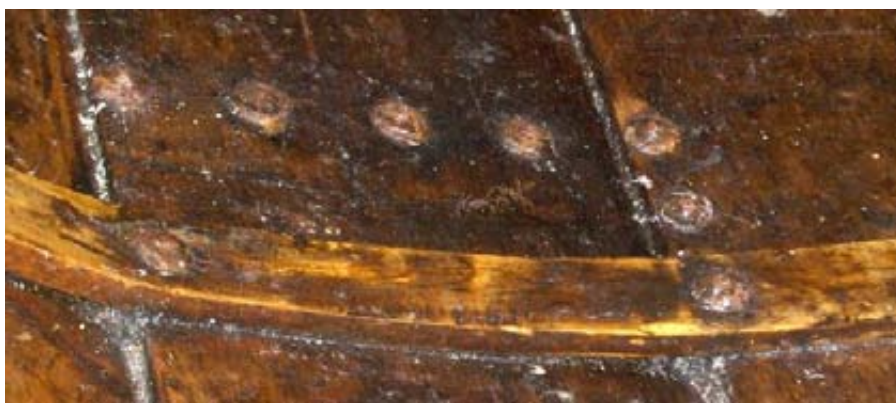
Fleire rør slik ein ser dei inne i færingen. Saumen går frå utsida av båten og gjennom borda, ein trer så ei ro inn på denne, og klinkar slik at enden på saumen vert butt og låser fast roa.
